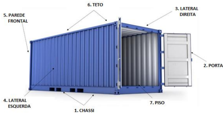
Fig. 11 – Inspeção dos sete pontos dos contêineres.
