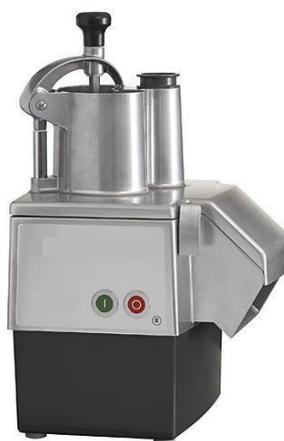
2. **Cortador de produtos hortícolas** (dimensões (A x L x P) 320 x 270 x 505 mm, peso 7,5 kg) para a preparação industrial de alimentos, equipado com um motor elétrico de 220 V, concebido para cortar
