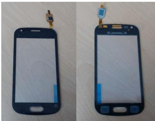
2. **Módulo de tela sensível ao toque de matriz ativa de diodos emissores de luz orgânicos (AMOLED)** (dimensões (L x C x A): 123 x 76 x 1 mm), para ser integrado num telefone celular. O módulo AMOLED funciona como um painel de comando sensível ao toque capacitivo para o telefone bem como uma tela, cuja diagonal da tela mede 5,3 polegadas (134 mm) e a resolução é de 1200 x 800 *pixels*.
