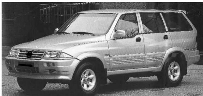
2. **Veículo automóvel de dez lugares**, com um motor de ignição por compressão (diesel) com cilindrada de 1.948 cm<sup>3</sup>, equipado com janelas laterais, quatro portas, uma porta traseira de levantar com vidro, dois
